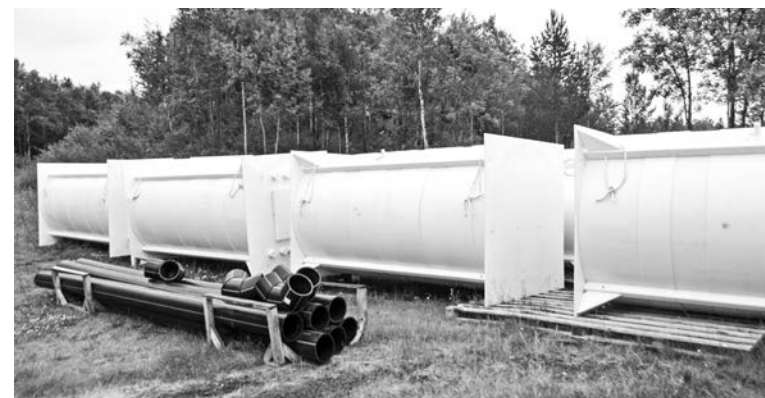
Очистка воды будет проходить с использованием 24-х реакторов.
